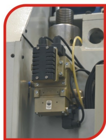
Válvula eletropneumática dupla monitorada CAT IV – NR12
